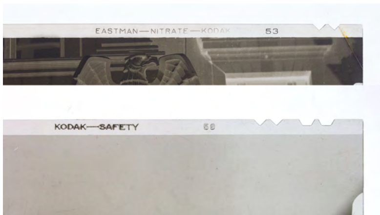
Figura 1. Texto del fabricante en negativos de nitrato de celulosa, y acetato o poliéster
